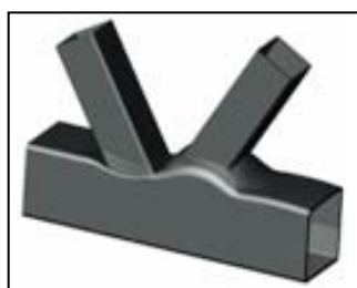
a) Plastificação da Face ou da Seção do Banzo
