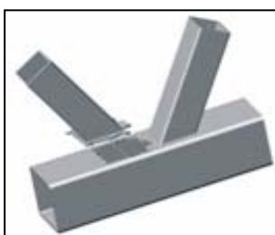
c) Ruptura da Solda de Diagonal ou Montante
