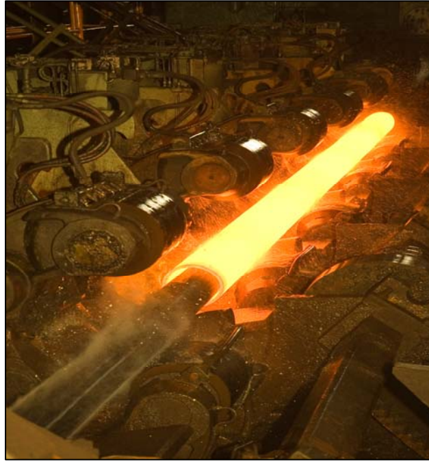
Figura 6 – Laminação a Quente de Perfis Circulares
