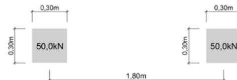
Figura 6.2 – Eixo-tipo simples para verificação de forças concentradas – Categoria III
