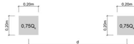
Figura 6.7 – Cargas concentradas para projeto de helipontos
